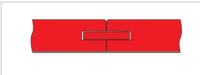
VARIANTE FÜR DIE VERBINDUNG VON ARBEITSPLATTEN
